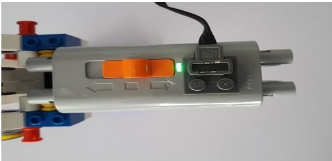
Мал. 3. Перемикач, клема та лампа блоку живлення
